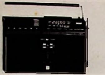
Der Radio-Recorder »anett« enthält nun im Niederfrequenz-Verstärker einen IC
