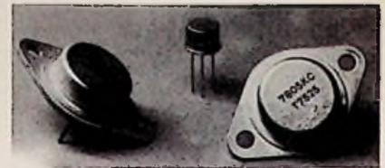
Die Spannungsregler von Transitron im T0-3- bzw. T0-5-Gehäuse
